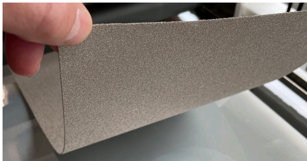
Nickelschaum mit offener 3D-Struktur
